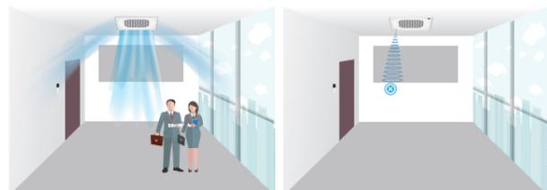
Внутренний блок автоматически запускается при обнаружении человека      Внутренний блок автоматически останавливается при выявлении отсутствия
