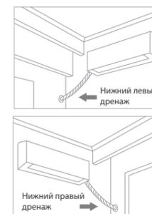
Большинство обычных настенных блоков не оснащены дренажным насосом, а трубу для отвода конденсата можно проложить только под блоком, полагаясь на то, что конденсат будет отводиться в ближайшее окно под действием силы тяжести.
