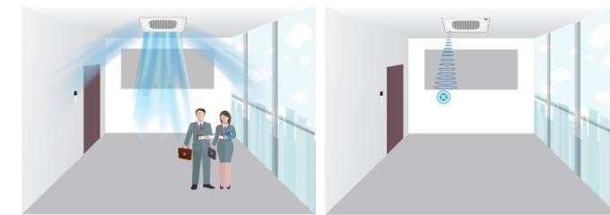
Внутренний блок автоматически запускается при обнаружении человека
